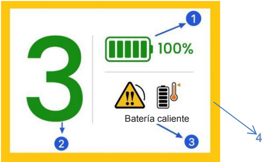
Fig. 3 Pantalla LCD cuando se activa la condición de alarma
